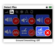
地面平滑功能位于Detect Plus页面。 地面平滑功能有三种设置,可根据 探测要求进行选择。
